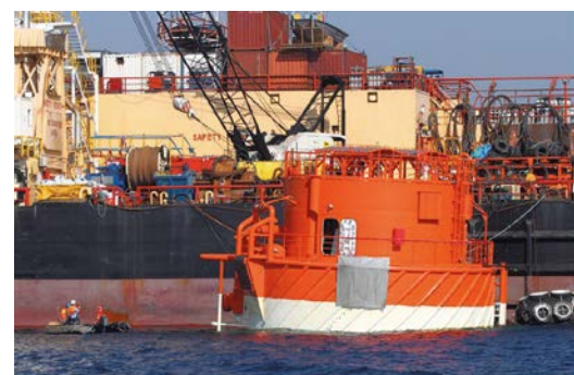
В России КТК – пионер в использовании прогрессивной технологии погрузки танкеров с помощью выносных причальных устройств
