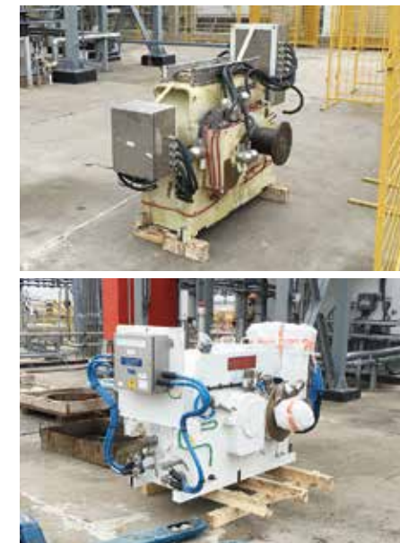
Алынып тасталған FLENDER редукторы мен жаңа LUFKIN редукторы
