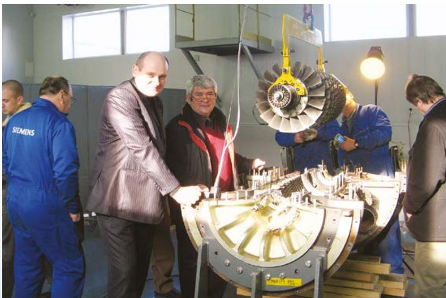
Поиск причин разрушения турбины
