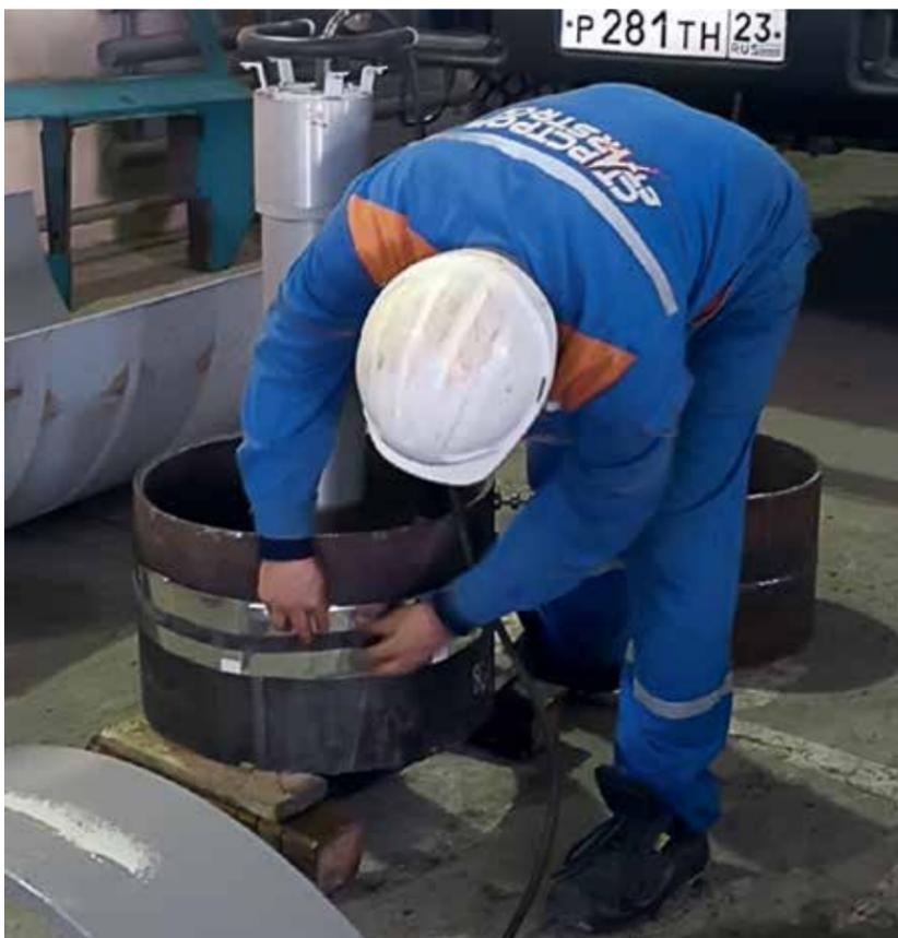
РАДИОГРАФИЧЕСКИЙ КОНТРОЛЬ СВАРНОГО СОЕДИНЕНИЯ НА БАЗЕ АВП «КРОПОТКИН»
