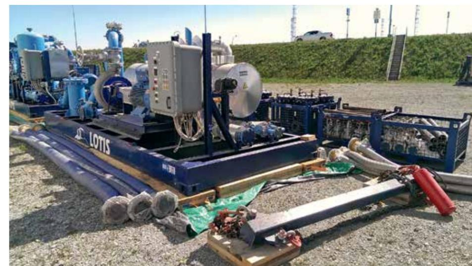
ОБОРУДОВАНИЕ ВНЕШНЕЙ СИСТЕМЫ РАЗМЫВА ДОННЫХ ОТЛОЖЕНИЙ РВСПК
