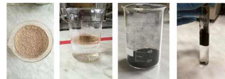
ВНЕШНИЙ ВИД СОРБЕНТА, ПОЛУЧЕННОГО ИЗ БОРЩЕВИКА СОСНОВСКОГО
