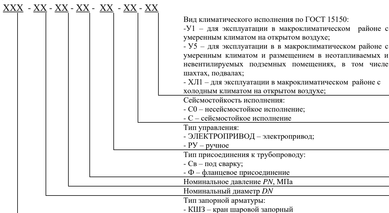
Рисунок 5.1 – Схема условного обозначения крана
