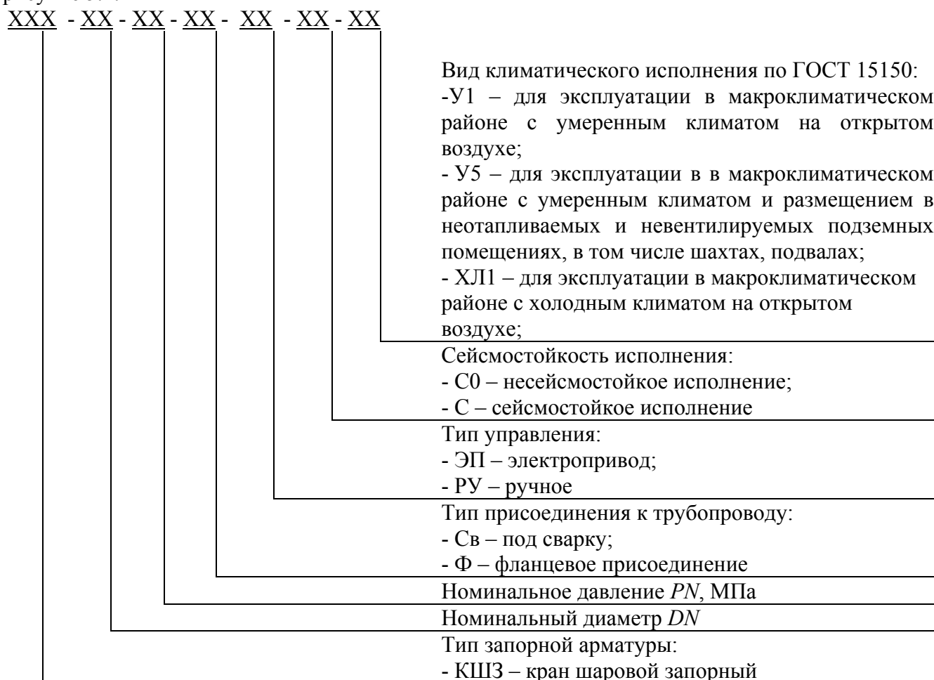
Рисунок 5.1 – Схема условного обозначения крана
