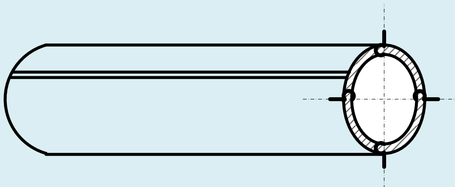
Рисунок Г.2 – Схема измерения толщины стенки труб
